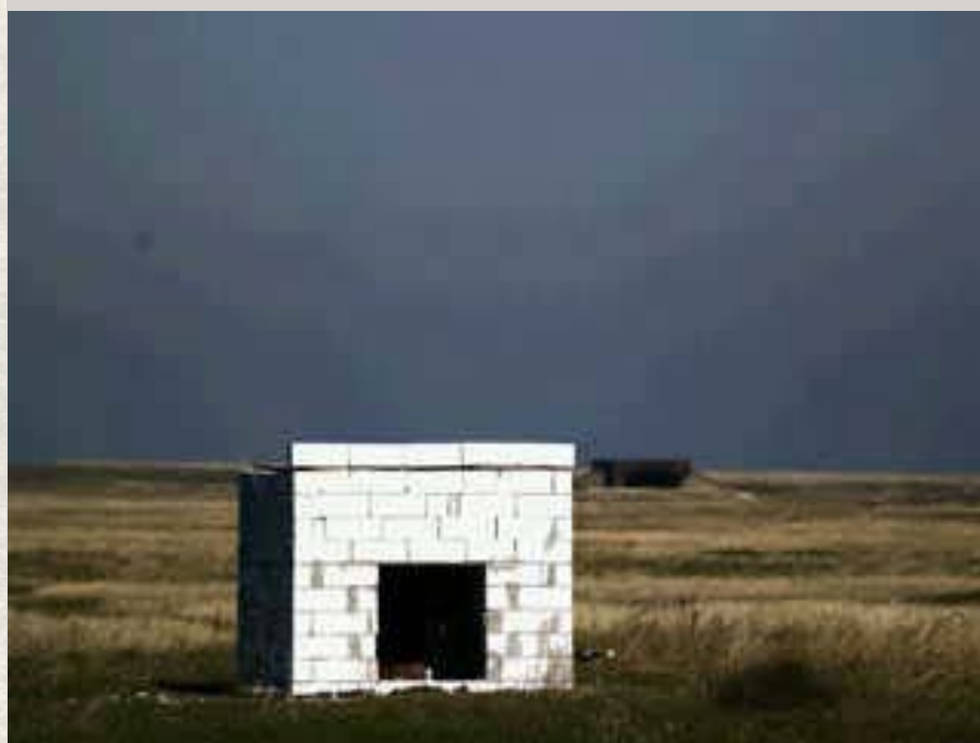
Efectul asupra unei construcții cu dimensiunile 3x3x3m, realizată din blocuri din BCA
